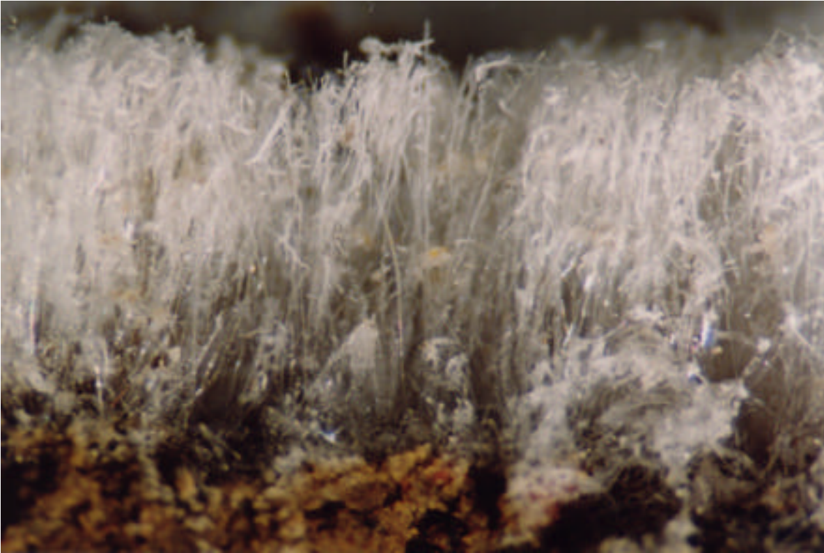
写真7 A圃場の塩類集積土壌の顕微鏡写真 塩類が析出している。
